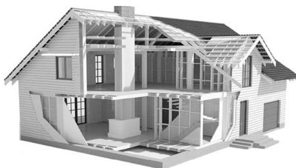
Рис 1. Каркасное домостроение.
