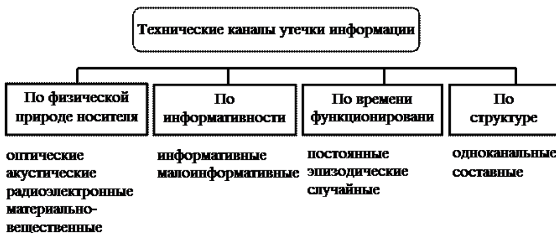
Рис. 2 Классификация технических каналов утечки информации [2]
