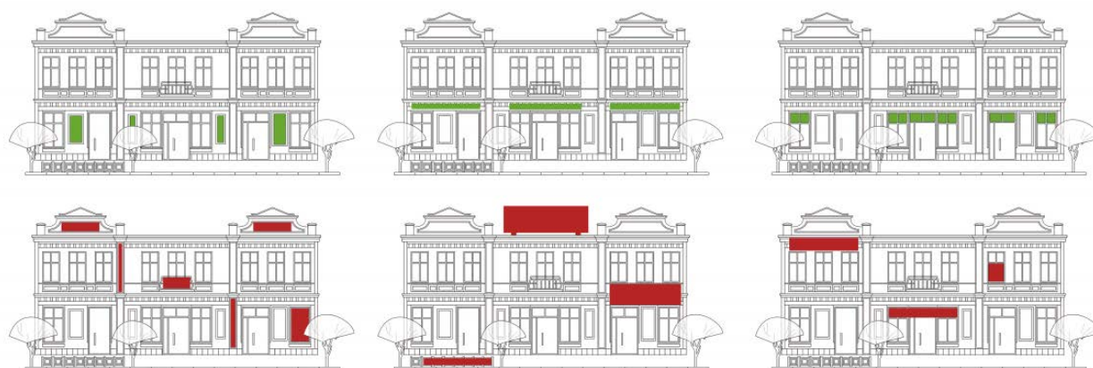
Рисунок 2 – Рекомендуемое и и запрещенное расположение информационных конструкций на фасадах здания [2]
