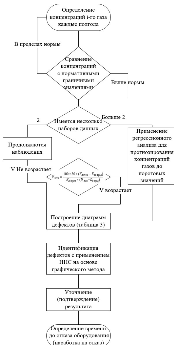
Рис. 1. Блок схема методики диагностики силового трансформатора (рисунок составлен авторами)
