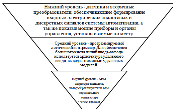
Рис.3 – Уровни системы автоматизации усовершенствованного процесса автоматического контроля и регулирования температуры в печи изменения расхода горючей смеси в горелки (авторская разработка)
