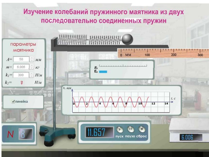
Рис. 1. Электронная экспериментальная задача по определению жесткости одной из пружин посредством теории колебаний
