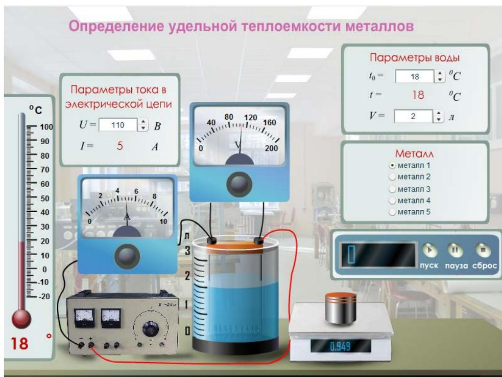
Рис. 2. Электронная лабораторная работа по определению удельной теплоемкости металлов
