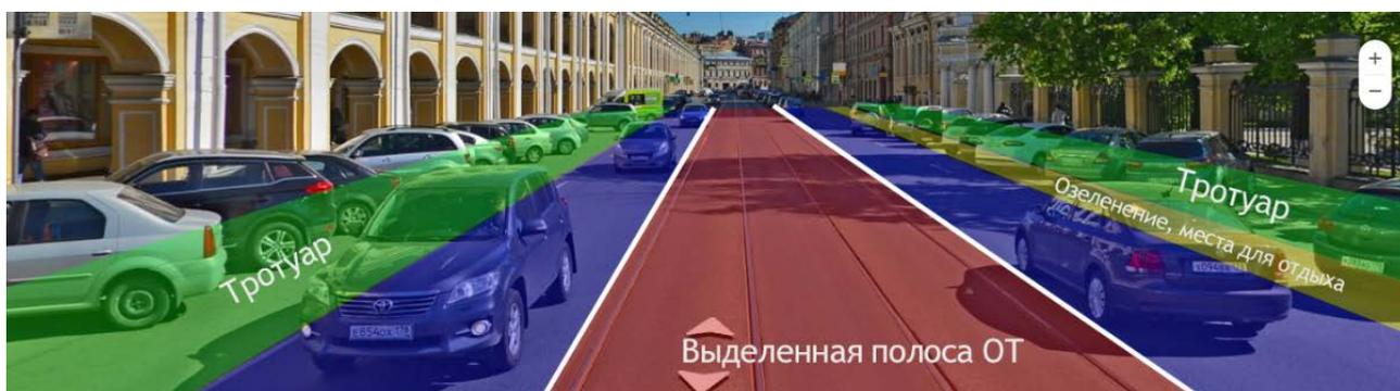
Рисунок 3. Декомпозиция предлагаемого устройства Садовой ул. [7]
