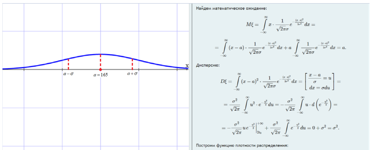
Рис.1 – График плотности нормального распределения и числовые характеристики. Источник: https://nomotex.ru
