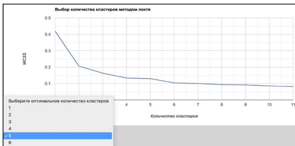
Рис. 7. Определение оптимального количества кластеров методом локтя
