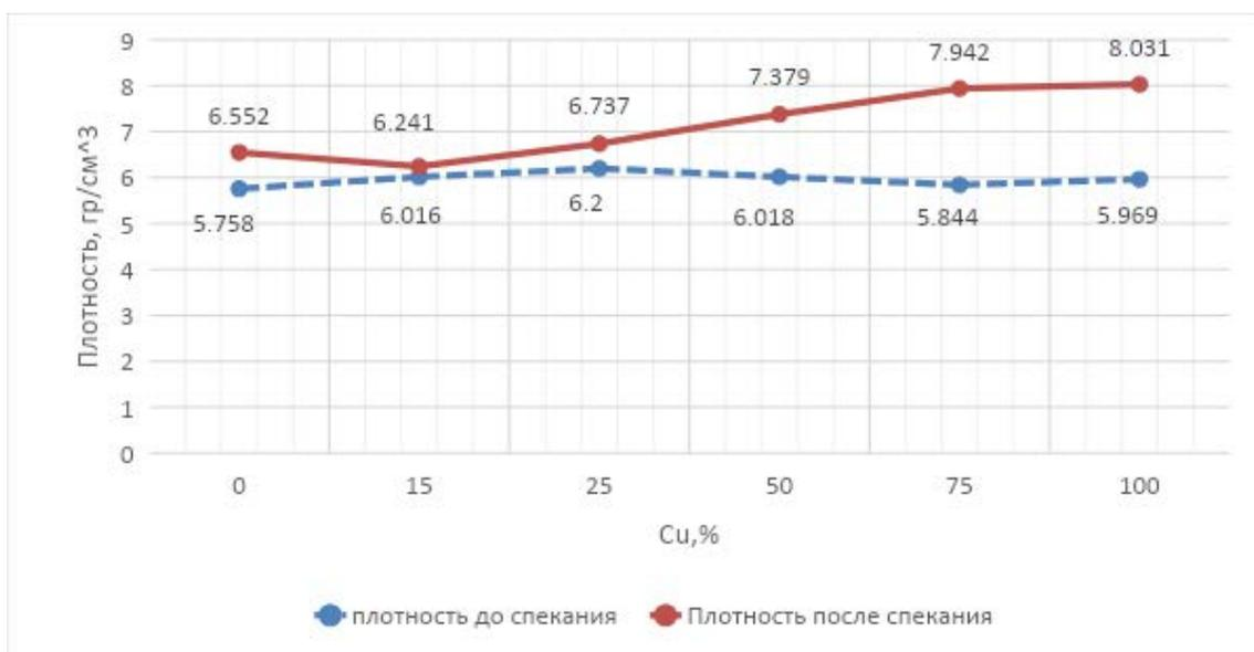
Рис. 4 Зависимость плотности от % содержания меди
