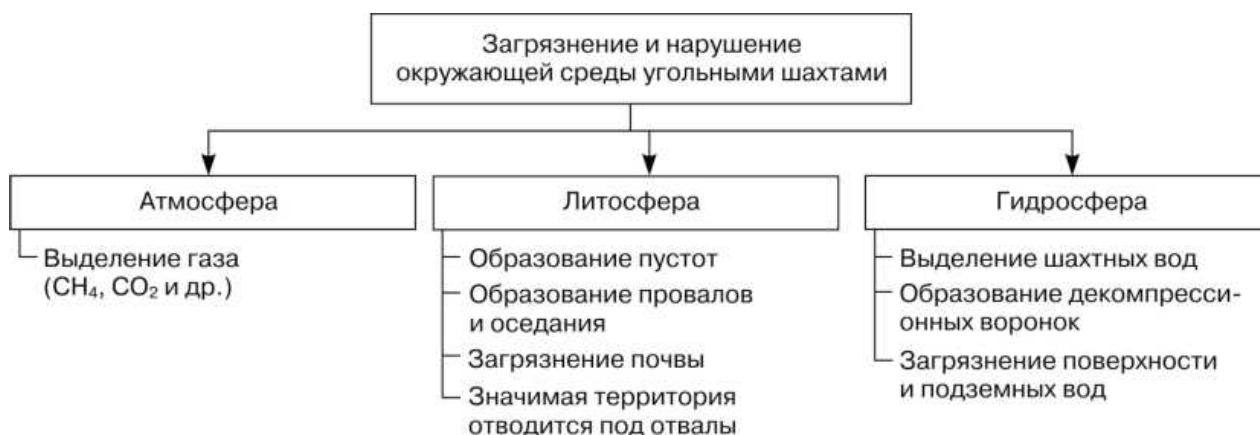
Рисунок 1 – Схема загрязнения и нарушения окружающей среды угольными шахтами 1
