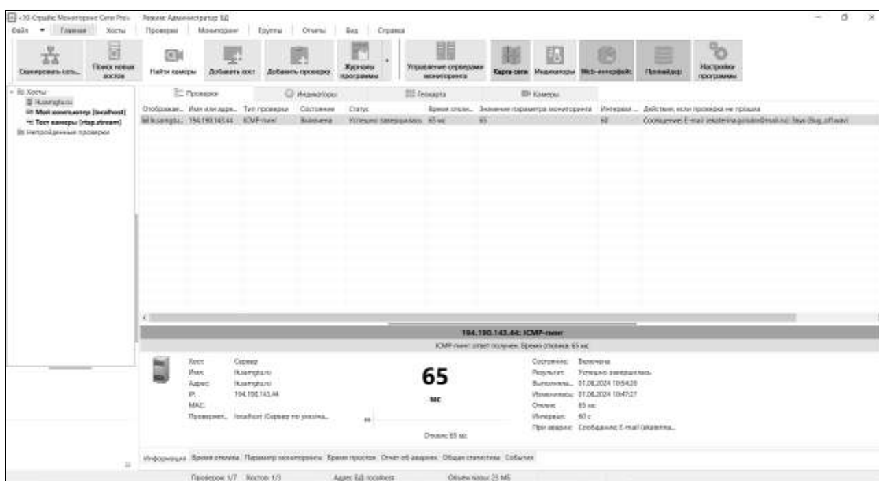
Рис. 5. Мониторинг доступности хоста с использованием ПО «10-Страйк: Мониторинг Сети»
